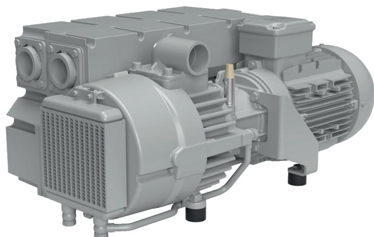
U 5.65 XL K mit 2,0 Liter Ölbehälter, Öl-Luft-Kühler und horizontalen, in 90°-Schritten drehbaren Sauganschluss.
